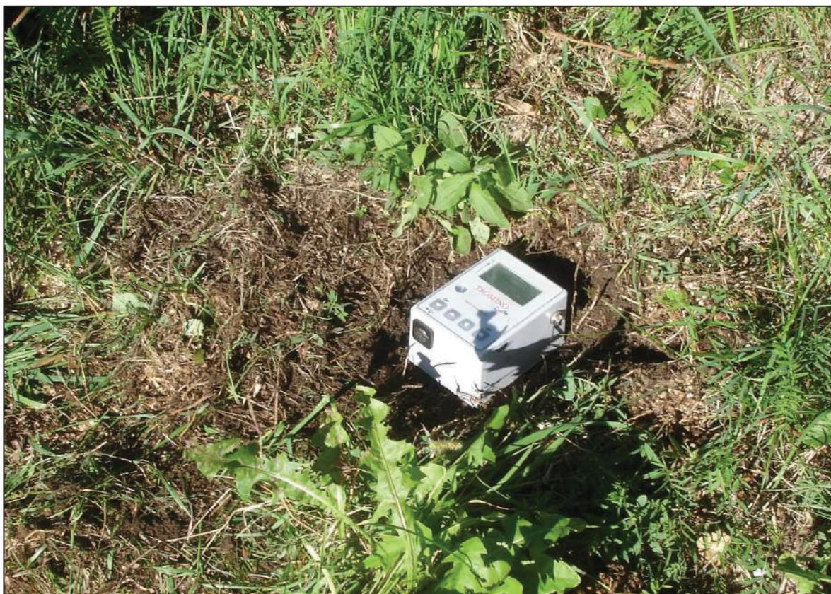
Fig. 5 – Punto di esecuzione indagine di sismica passiva con strumentazione TROMINO ®
